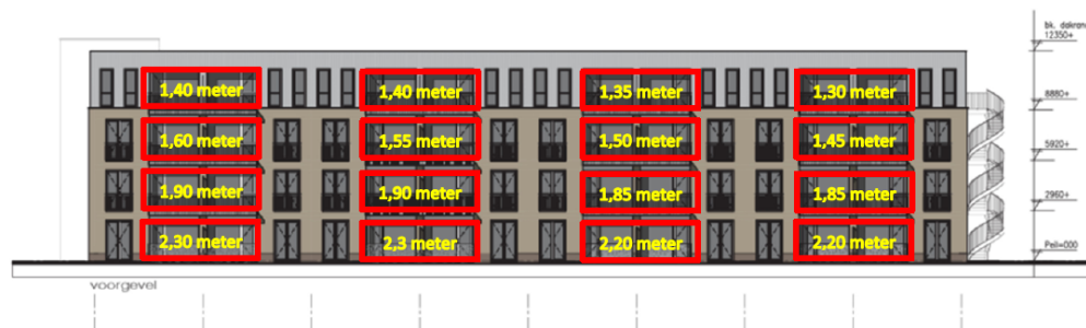
Figuur 4.1: Minimale hoogte glazen afscheiding balkons per bouwlaag
