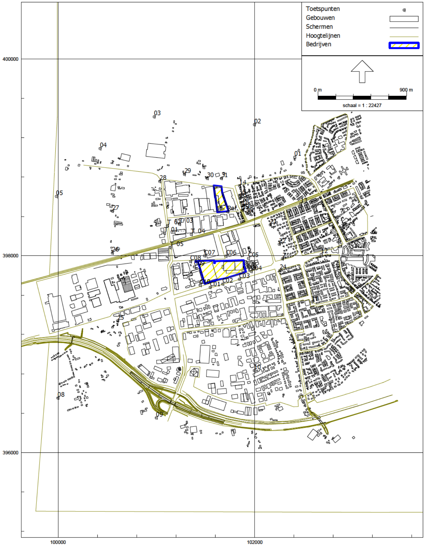
figuur 3b: Overzicht rekenmodel met positie rekenpunten geluidzone
