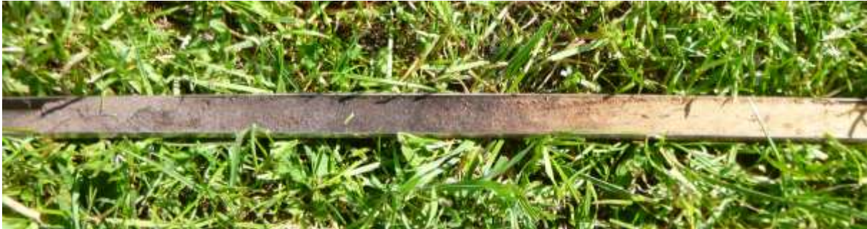
Figuur 24: Foto van de voor het plangebied kenmerkende bodemopbouw met links de bouwvoor, in het midden de laag moerig zand, rechts daarvan de tijdens de veenvorming doorwortelde top van het dekzand met daarin oxidatievlekken en geheel rechts de geelgrijze C-horizont van lemig fijn dekzand.
