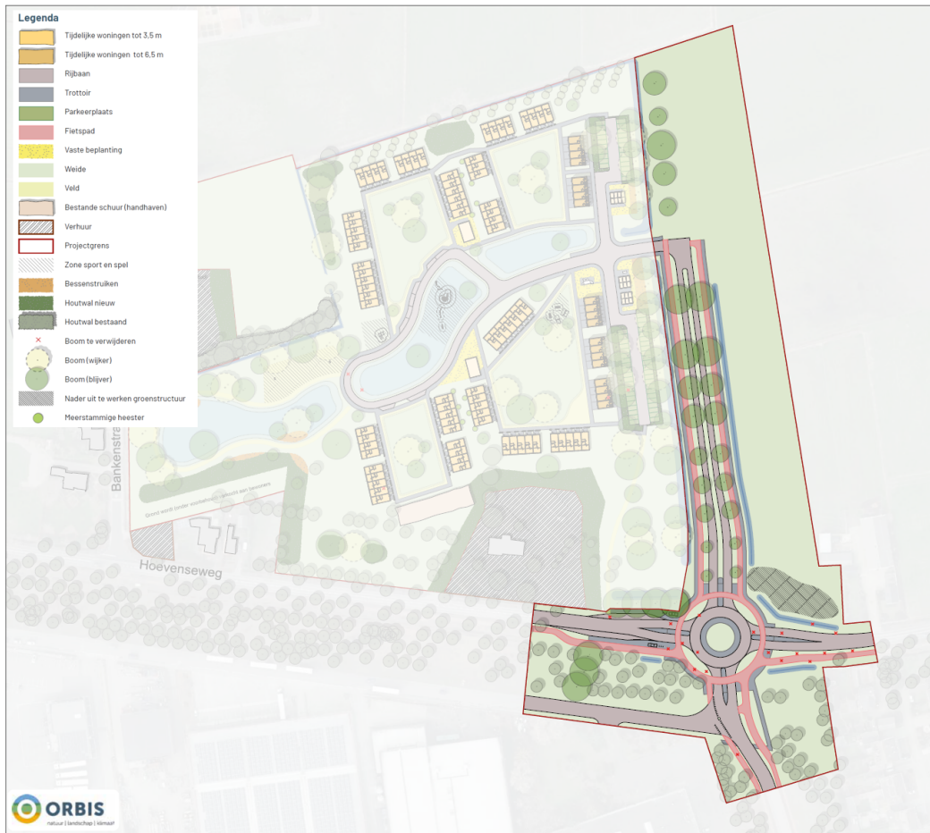
Figuur 2.4 Definitief ontwerp rotonde en ontsluiting (locatie tijdelijke woningen is alleen indicatief weergegeven; hiervoor wordt een afzonderlijke procedure gevoerd).
