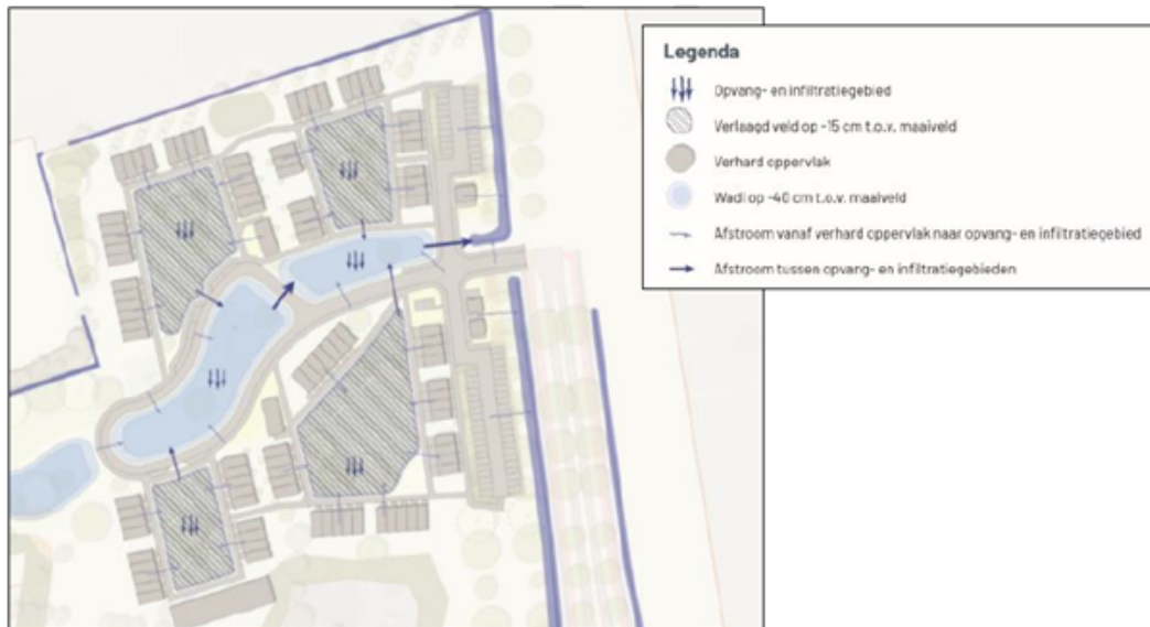
Figuur 4.3 Schematische weergave van het aan te leggen watersysteem
